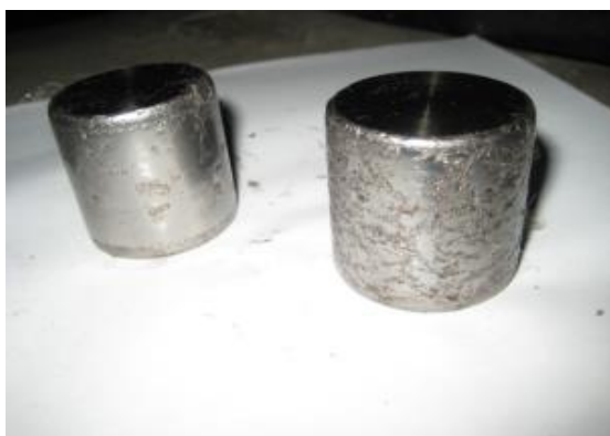
17 Сурет - Тірек роликтерінің бетіндегі тозудың іздері
