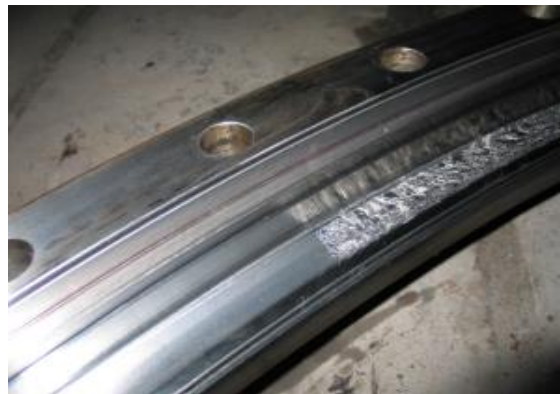
18 Сурет - Мойынтіректің жүру жолдарында шаршаудан пайда болған бояу
