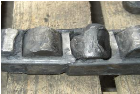
15 Сурет - Сепаратордың зақымдануы және роликтердің деформациясы
